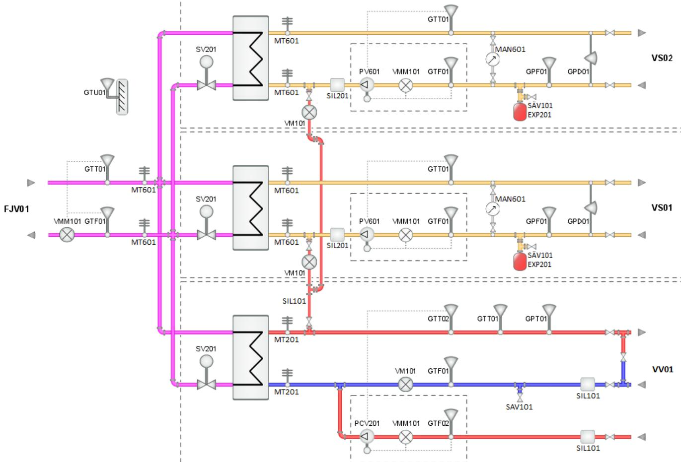
Temperaturgivare VS01-GTT01 och VV01-GTT02 ansluts till respektive cirkulationspump.
